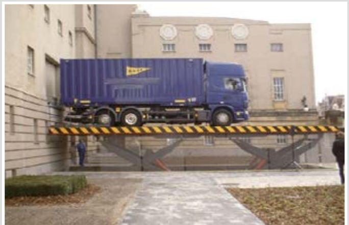
Nutzlast: 16.000 kg, Hub 2.850 mm Fahrwerk mit Getriebemotor
