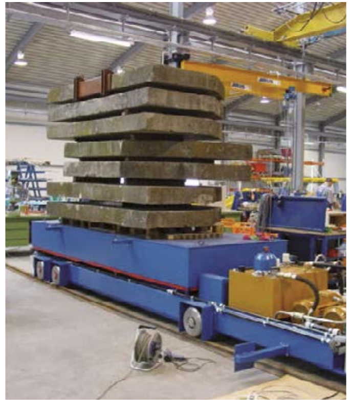
Nutzlast: 16.000 kg, Hub 2.850 mm Fahrwerk mit Getriebemotor
