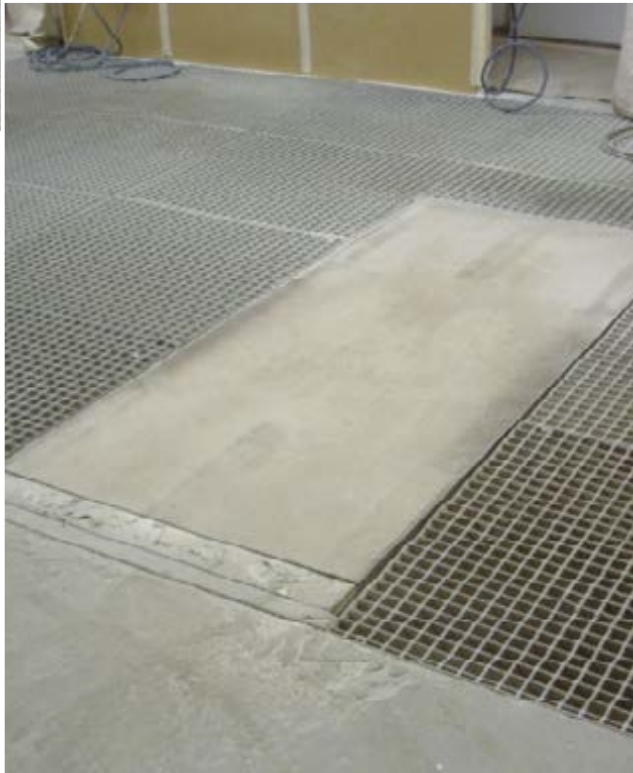
Nutzlast 1.000 kg, Plattform 1.980 x 980 mm, Hub 1.200 mm Einsatz in Lackierkabine, EXGESCHÜTZTE Ausführung! Teleskopschürzen, Gummischaltleiste
