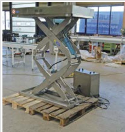
Nutzlast: 300 kg Hub 1625 mm NIRO-Ausführung
