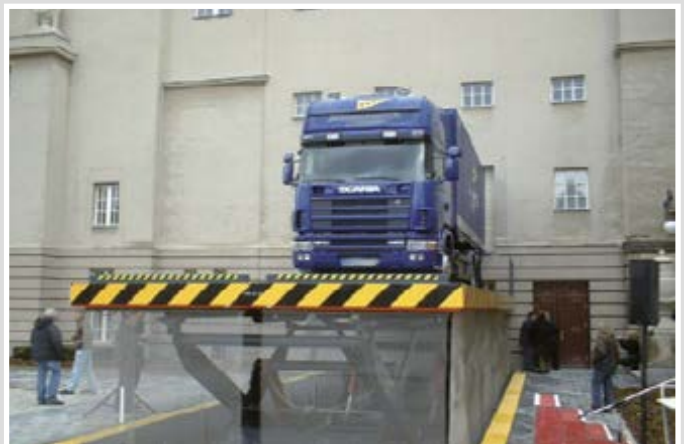
Hebebühne mit einer Plattform von 14.0 x 4.5 m, Nutzlast 25 t
