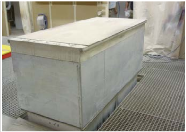
Nutzlast 1.000 kg, Plattform 1.980 x 980 mm, Hub 1.200 mm Einsatz in Lackierkabine, EXGESCHÜTZTE Ausführung! Teleskopschürzen, Gummischaltleiste
