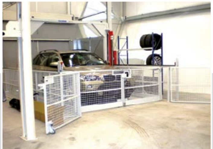
Autohebebühne als 2-Säulenheber, Nutzlast 2.5 t, Nutzhub 3.64 m
